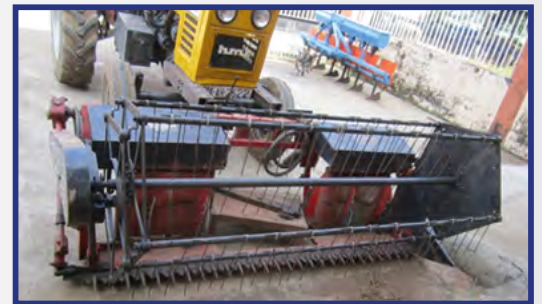
चित्र 5. ट्रैक्टर माउंटेड वर्टिकल कन्वेयर रीपर
