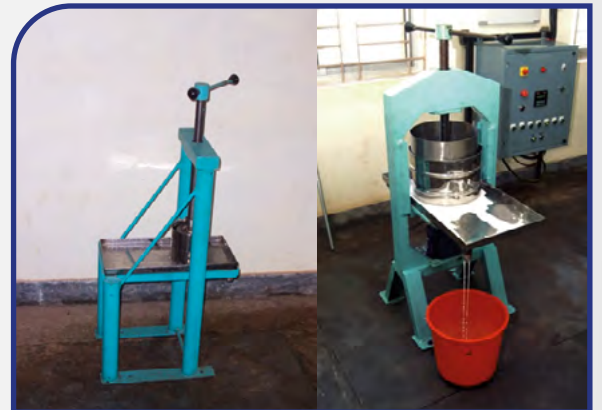
चित्र 1. हस्तचालित नारियल दूध निकालने की मशीन
