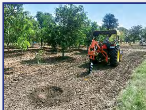
चित्र 3. ट्रैक्टर चालित पोस्ट होल डिगर
