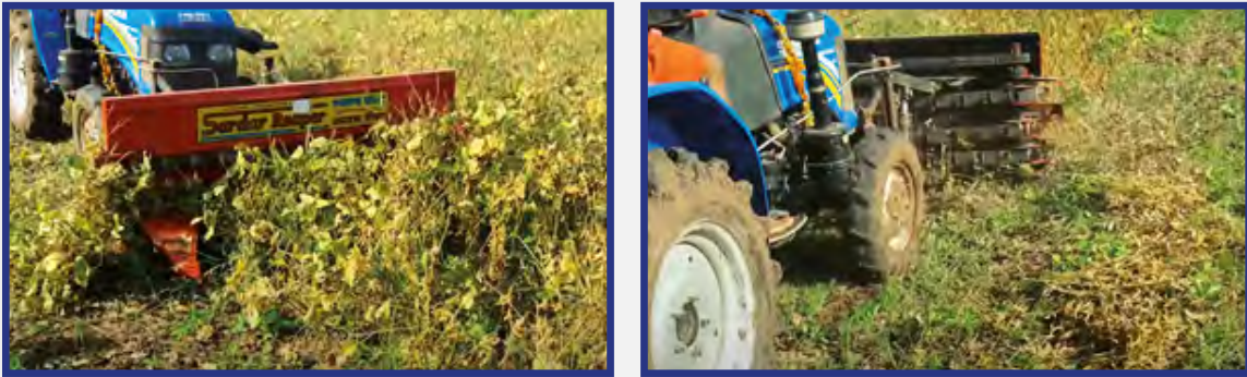
चित्र 4. ट्रैक्टर चालित ऊर्ध्वाधर कन्वेयर रीपर
