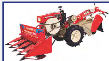
चित्र 3. पावर टिलर संचालित वर्टिकल कन्वेयर रीपर
