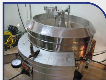
चित्र 9. कृषि अवशिष्टचालित वर्जिन नारियल तेल कुकर
