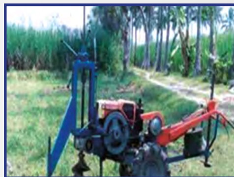
चित्र 2. पावर टिलर चालित पोस्ट होल डिगर
