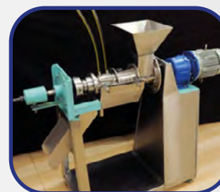
चित्र 4. शीतलन प्रणाली युक्त नारियल दूध निकालने की मशीन
