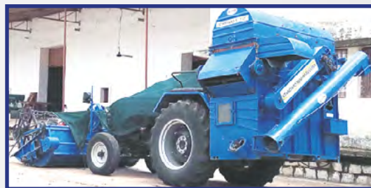
चित्र 7. ट्रैक्टर चालित कंबाइन हार्वेस्टर
