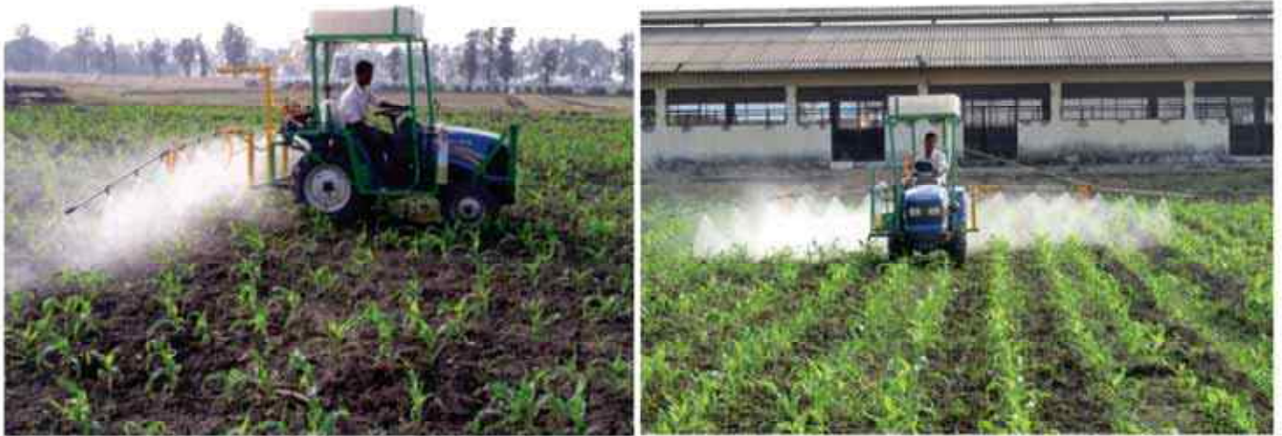
चित्र 1: छोटे ट्रैक्टर से चलने वाले बूम स्प्रेयर का खेत में परिक्षण
