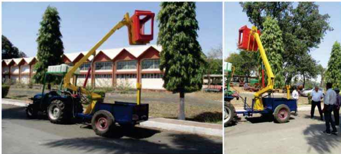
चित्र 1: बागवानी फलों के लिए पेड़ों की कटाई, छंटाई और छिड़काव के लिए छोटे ट्रैक्टर ट्रॉली द्वारा चलित हाइड्रोलिक फ्रूट प्लेटफार्म
